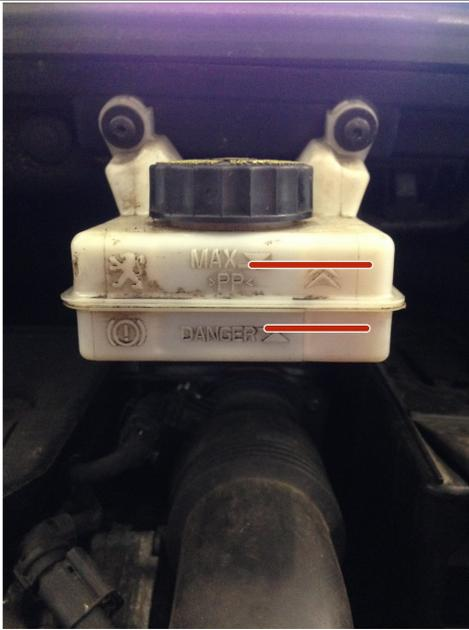
⚠ Pompé sur la pédale de frein jusqu'à ce qu'elle devienne dure, et vérifier le niveau de **liquide de frein** qui doit être entre le mini et maxi
